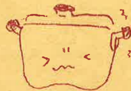
☆鍋底の形が変わったり (熱膨張による変形)
